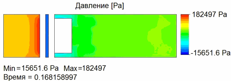
Рис. 3. Эпюра давлений (вид справа)
