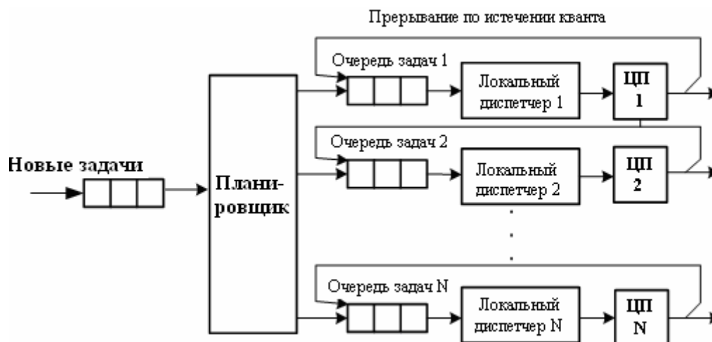
Рис. 3. Модель многопроцессорной системы с локальными диспетчерами
