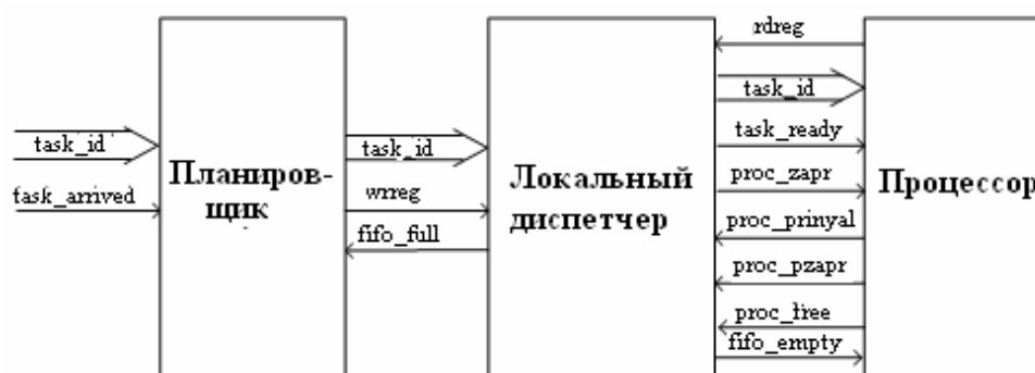
Рис. 4. Интерфейс взаимодействия локального диспетчера с планировщиком задач и процессором
